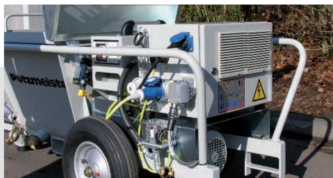
Свободный доступ к электродвигателю и компрессору. Простота снятия компрессора при необходимости.
